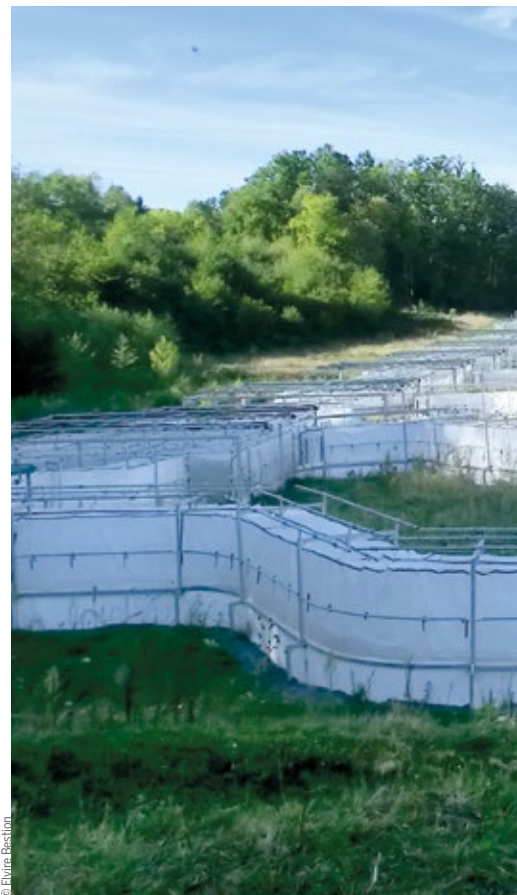
▲ Les 48 cages interconnectées du Métatron permettent de soumettre les espèces vivantes à des variations de température, de lumière et d'humidité et d'étudier leurs mouvements en réponse à ces changements environnementaux.
